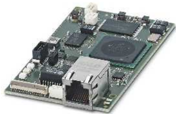
Встроенный маршрутизатор/межсетевой экран с VPN
