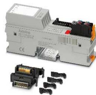
16 выходов, разъем FLK20 для системной кабельной разводки
