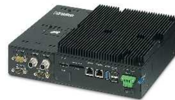
Блочный ПК с процессором Intel® Atom™-E3845
