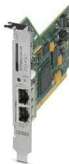
Маршрутизатор с межсетевым экраном для PCI, опционально с VPN
