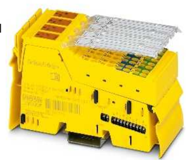
Подключение макс. к 16 входным/выходным модулям безопасности
