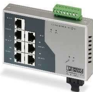
7 / 15 портов RJ45 и 1 оптический порт
