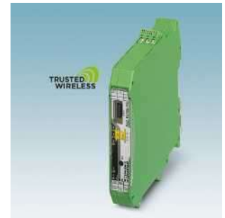
Многоточечный мультиплексор для шинной системы RS-485
